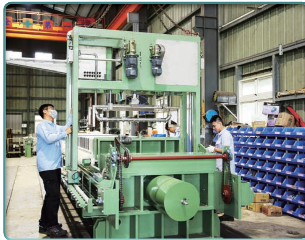
因應科技潮流，太和已啟用AIoT技術，在壓濾機上安裝各種感測器，收集流量、壓力、閥件動作、機電運轉等資訊。
