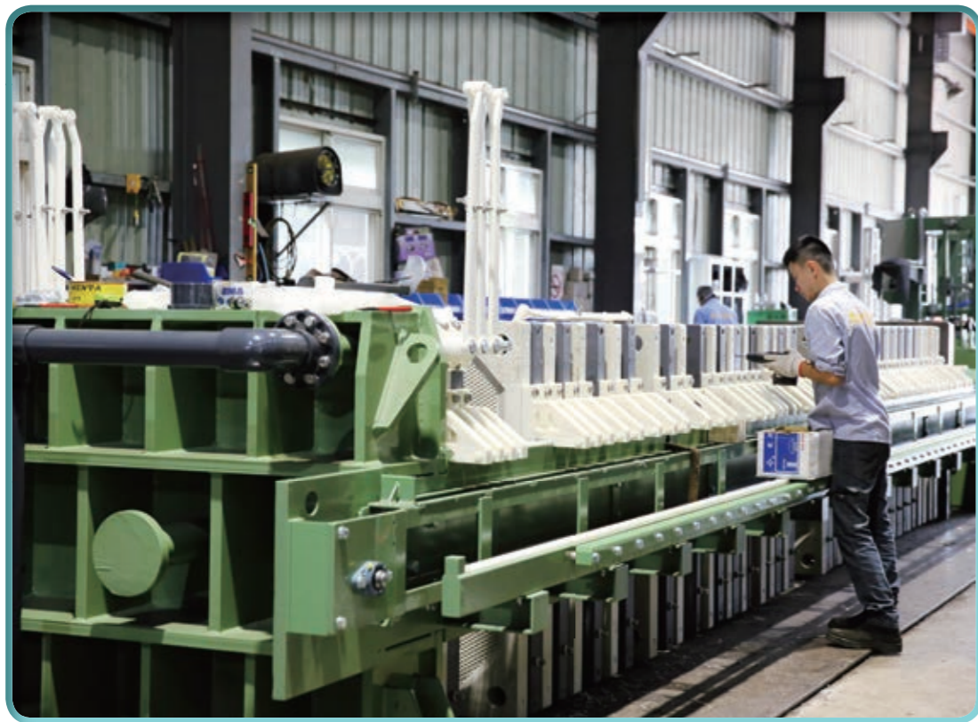
太和改良難以回收處理的傳統濾板，改採PP材質製作，容易切割、粉碎，並製成其他塑膠產品。圖為技術人員正為PP濾板上濾布。
